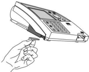
3. Den Reagenz-CODE CHIP™ nach abgeschlossener Datenübertragung aus dem Messgerät nehmen.
