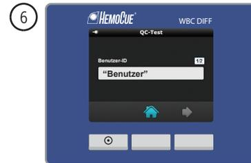
Der QC-Test ist eine Qualitätskontrolle, bei der die Funktion des Analyzers mit Kontrollmaterial geprüft wird.
