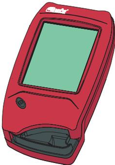
Der Kuvettenhalter sollte täglich nach Gebrauch gereinigt werden. Eine verschmutzte optoelektronische Einheit kann zur Anzeige eines Fehlercodes durch den Analyzer führen. So reinigen Sie den Kuvettenhalter und die optoelektronische Einheit:
